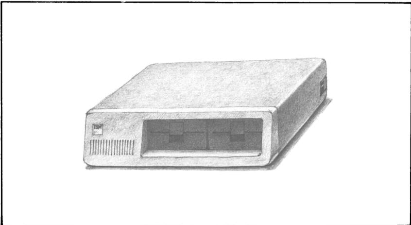
Al suo interno c'è la cosiddetta scheda di sistema, che contiene i circuiti integrati, i vari collegamenti e gli alloggiamenti (slot) per le schede di espansione e di interfaccia. Su questa scheda è naturalmente situato il processore, che è lo 8088 della Intel.
